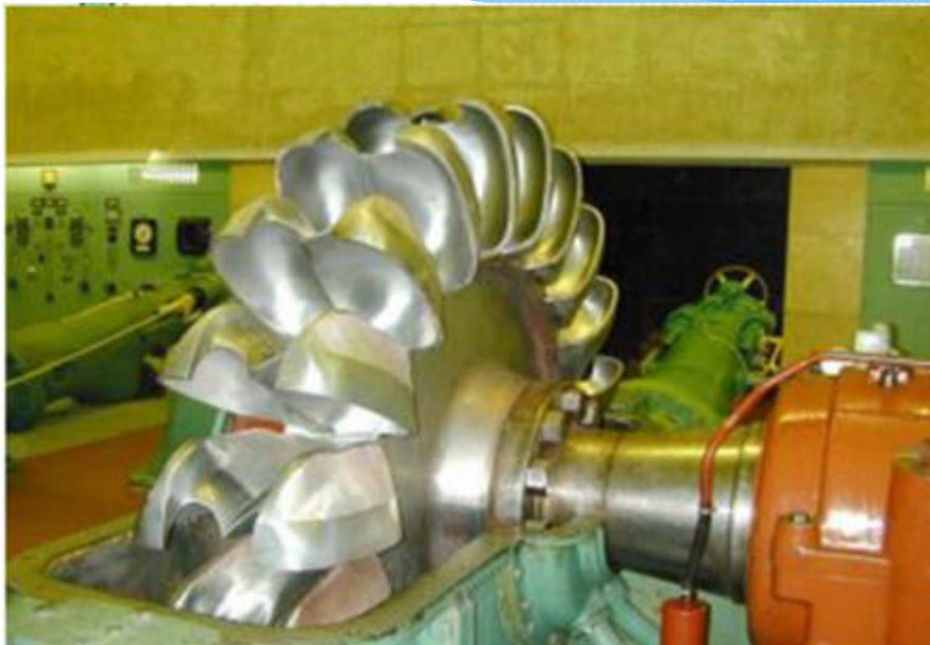
PELTON TURBINE , za padove vode (od 50 do 1000 m) vodoravn ili uspravan položaj vratila
