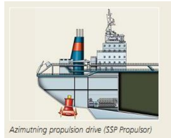
Izvedba s elektromotorom kao porivnim strojem (dizel-električki propulzijski sustav)
