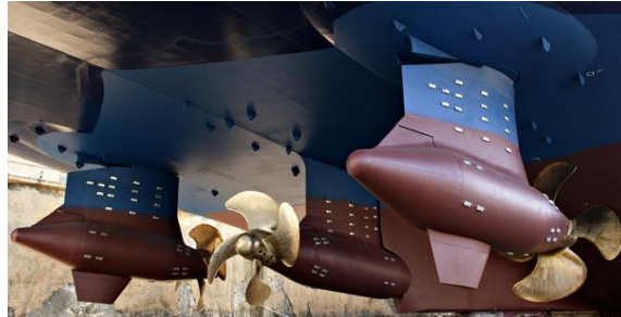
Slika 9: Prikaz azimutnih potisnika u paru sa fiksnim krmenim potisnicima
