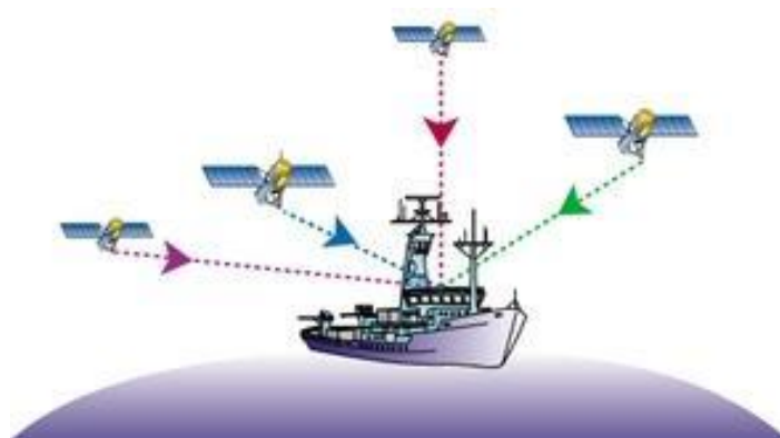
Slika 13: Način determiniranja lokacije koristeći GPS sustave i satelite
