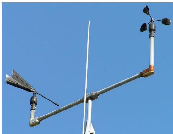
Slika 14: Prikaz sustava za mjerenje brzine i snage vjetra – Anemometar
