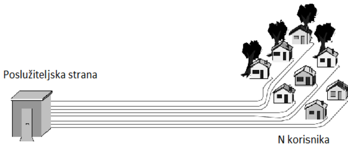
Slika 27. Topologija od točke do točke Izvor: The handbook of optical communication networks Doradio autor
