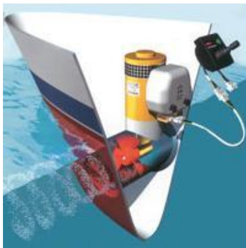
Slika 24. Sustav pramčanog propelera
