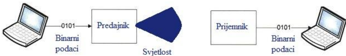
Slika 14: Pojednostavljeni bežični komunikacijski sustav
