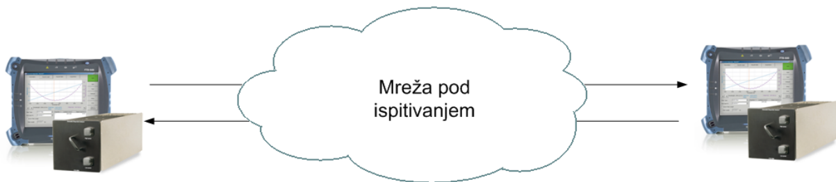
Slika 30: Konfiguracija za ispitivanje dvostrukim setom opreme
