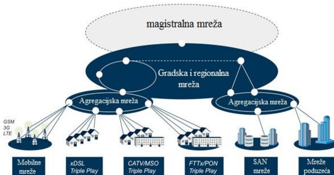
Slika 36. Podjela svjetlovodnih mreža
