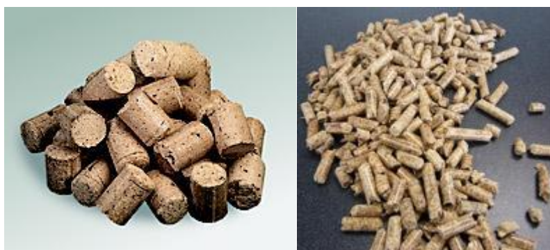
Slika 7.: Proizvod biomase – briketi i peleti
