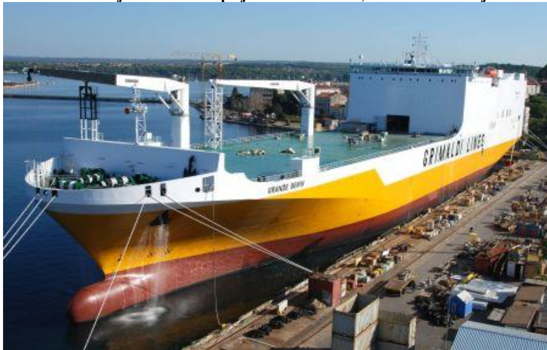
Slika 2. Višenamjenski brod za prijevoz automobila, kamiona i kontejnera
