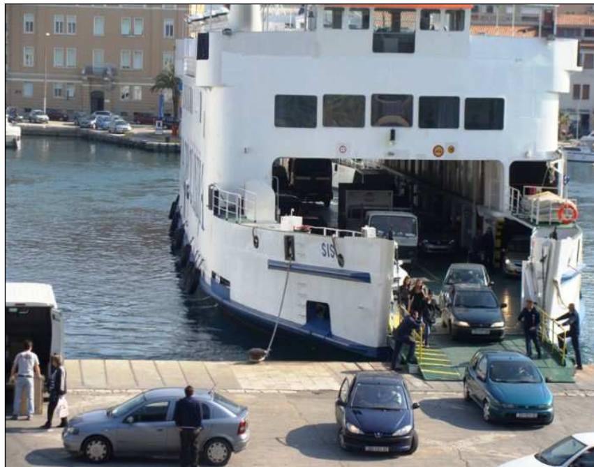
Slika 2: Iskrcaj iz RO-RO broda korištenjem krmenih/pramčanih vrata (rampe)
