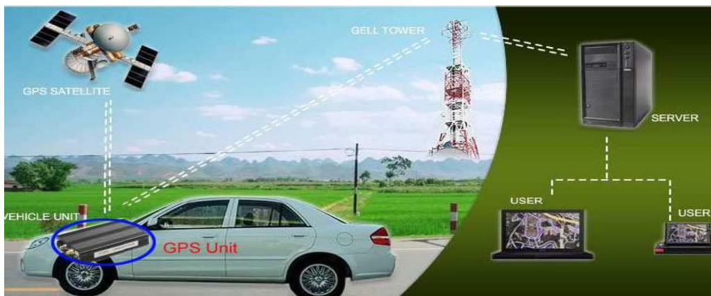
Slika 21. Princip rada GPS sustava
