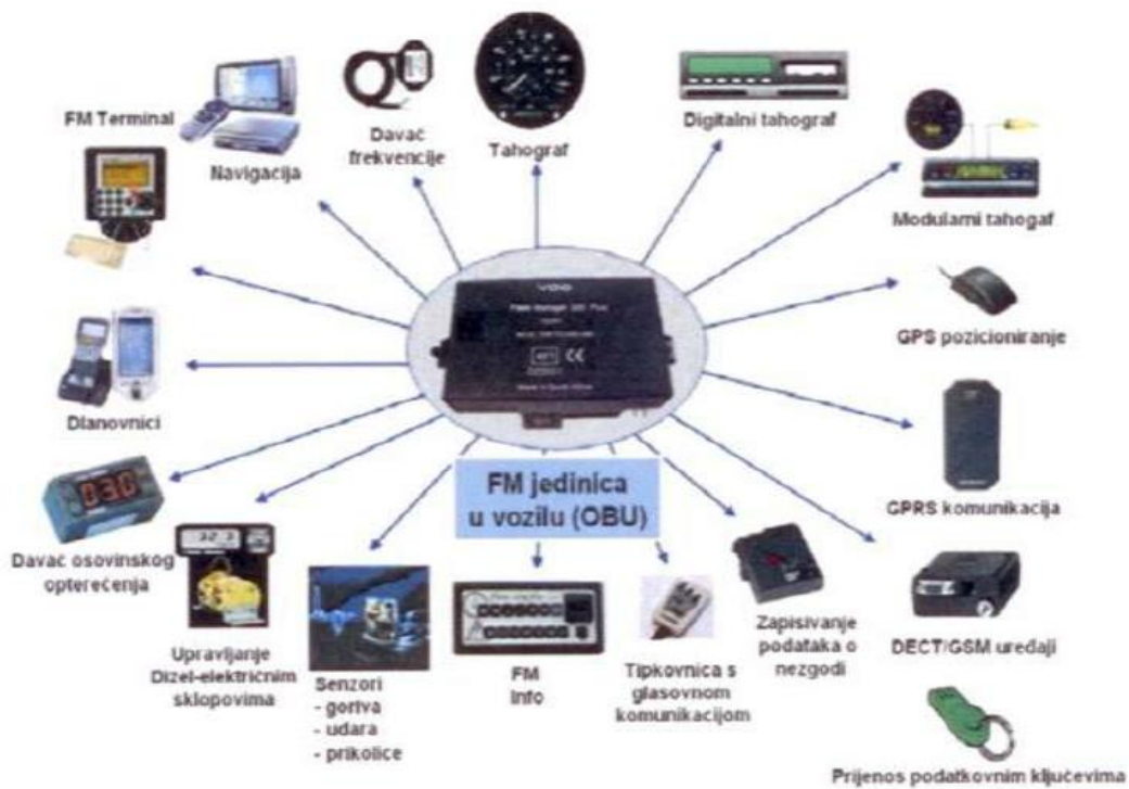
Slika 25. Simens VDO Fleet Manager – periferija i nadogradnje
