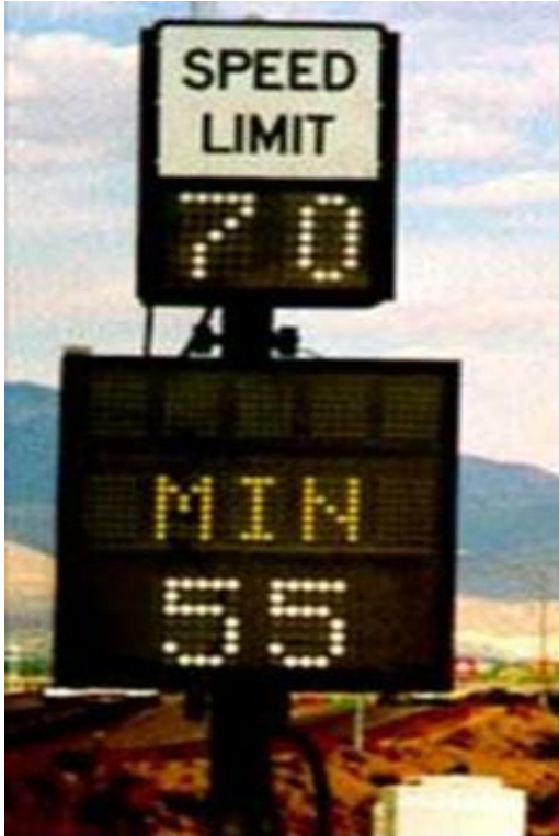
Slika 14: Primjer sustava koji regulira promjenjiva ograničenja brzine kretanja po cestama
