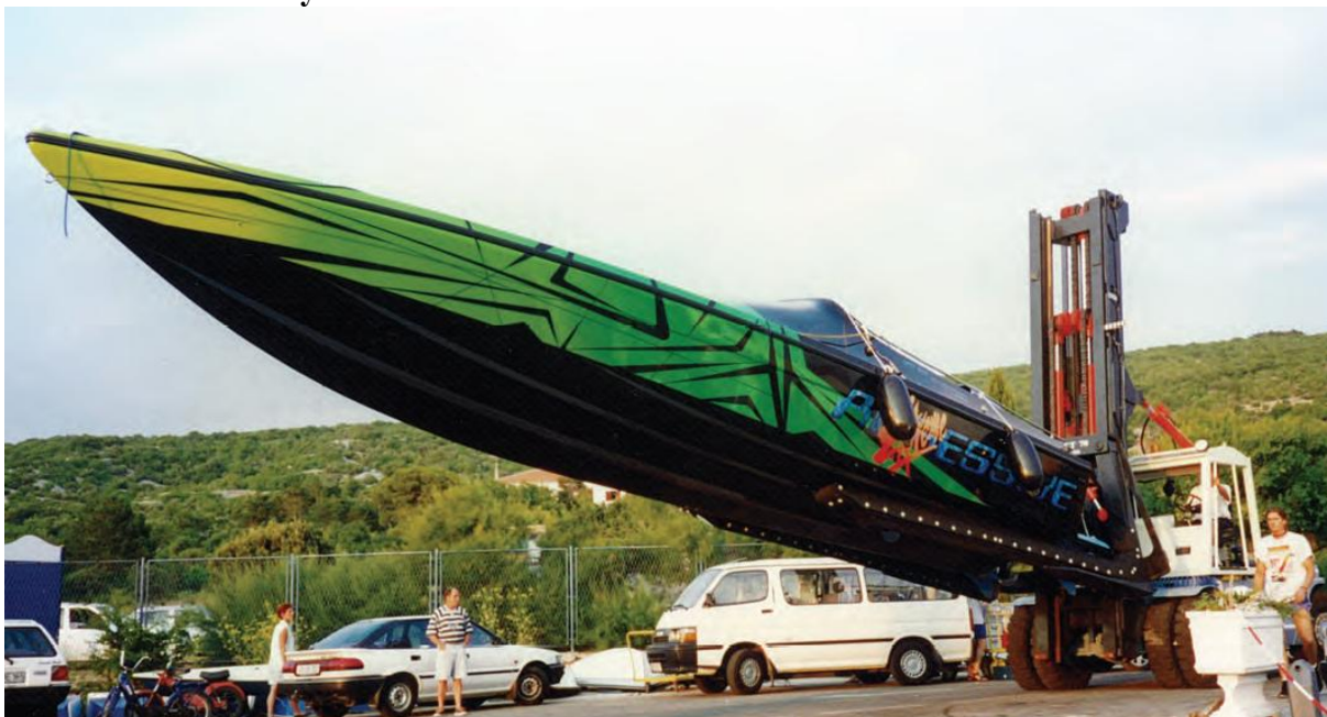
Slika 13. Dizalica Hydrolift 70 za brodice težine do 7 tona
