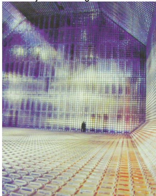
Slika 11. Prikaz unutrašnjosti Technigaz Mark III tanka
