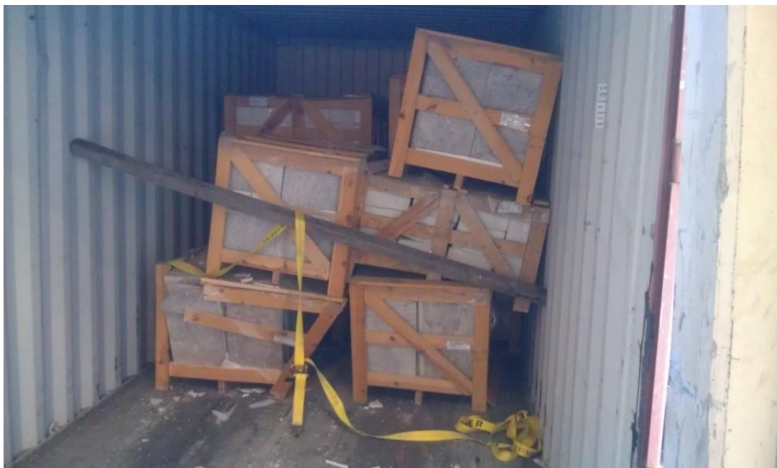
Slika1: Prijmer lošeg načina slaganja i učvršćivanja tereta u kontenjerima te njegove posljedice.
