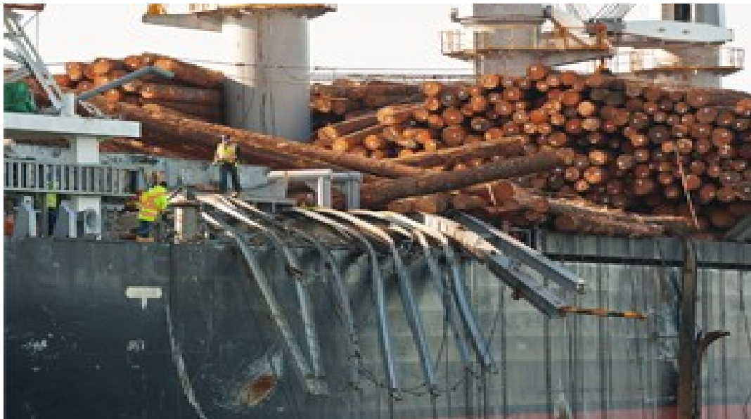
Slika 2 :Posljedica oštećenja uzrokovana olujnim vjetrom i valovima
