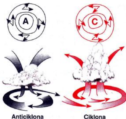
Slika 7: Ilustrirani prikaz strujanja zraka u cikloni i anticikloni
