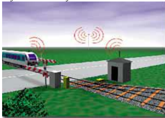
Slika 20. Prijenos informacija sa ŽCPR-a u lokomotivu putem GSM-R -a
