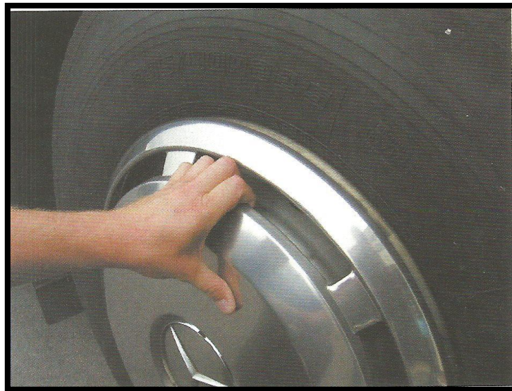
Slika 10. – Ako vozilo nema poklopac naplatka potrebno je pregledati da li su svi vijci na kotaču i jesu li odgovarajućeg tipa
