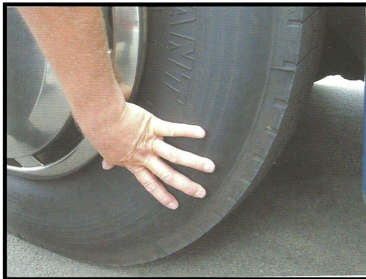
Slika 11. – Detaljan pregled bočnice gume i mogućih oštećenja uslijed udarca u nogostup
