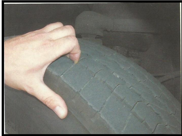
Slika 9. – Kontrola dubine šare na gaznoj površini gume
