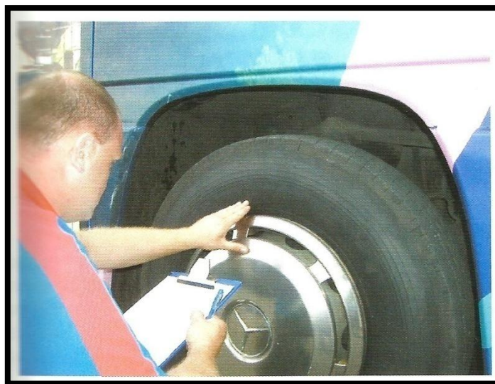
Slika 8. – Kontrola kotača s njegove vanjske strane
