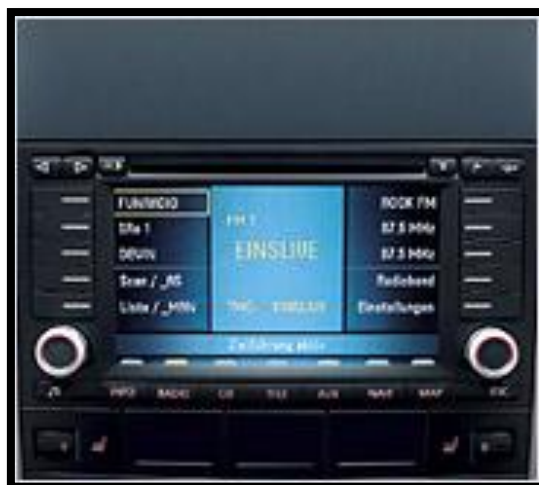
Slika 7. RDS sustav u automobilu
