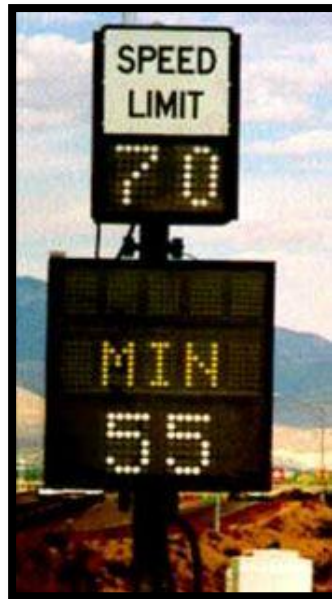
Slika 3. Primjer sustava koji regulira promjenjiva ograničenja brzine kretanja po cestama
