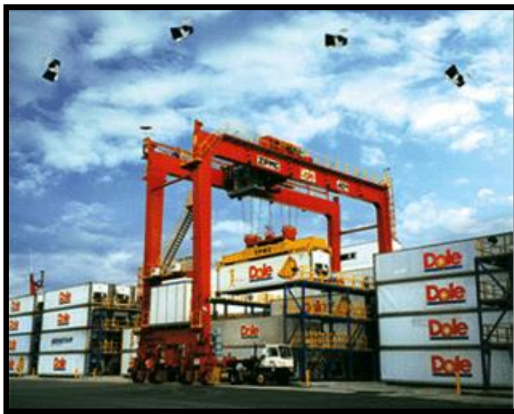
Slika 8. RTG dizalica s GPS sustavom, Hong Kong
