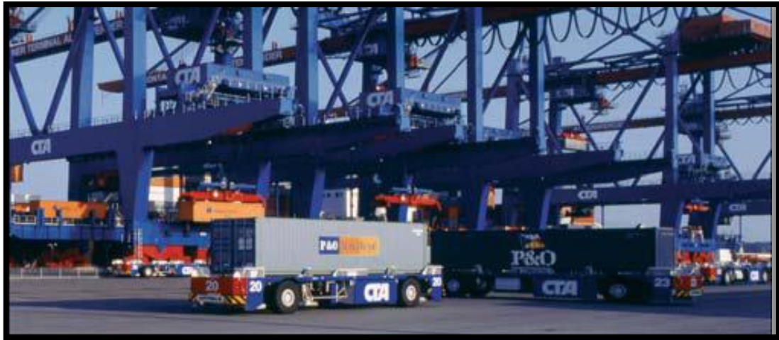
Slika 7. Flota automatski vođenih vozila koja prevozi kontejnere s pristaništa u skladišne depoe
