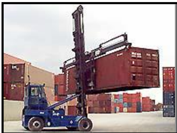
Slika 10. Primjer viličara koji podiže kontejner
