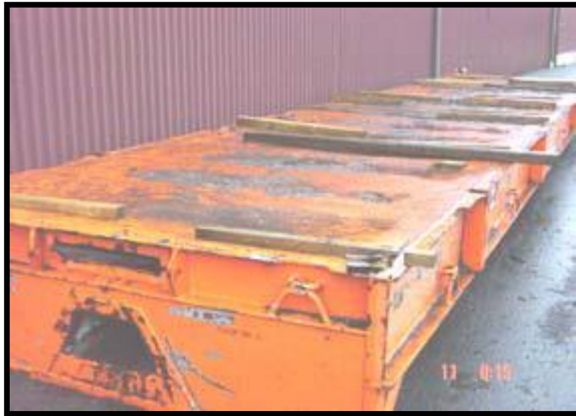
Slika 9. Poluprikolica niske platforme MAFI
