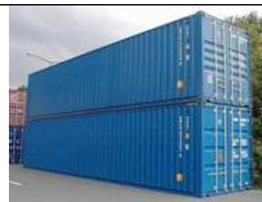
Slika 12. 40' Highcube kontejner Izvor: http://www.dancontainers.dk (srpanj, 2013.)
