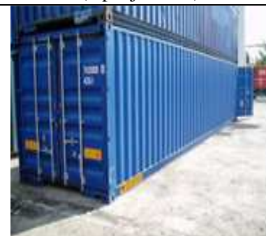
Slika 21. 40' Kontejner otvoren s dvije strane Izvor: http://www.dancontainers.dk (srpanj, 2013.)
