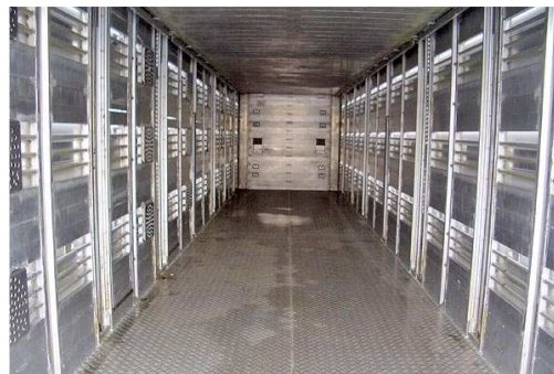
Slika 39. Kontejner za prijevoz živih životinja Izvor: http://www.livestock_container.com (srpanj, 2013.)
