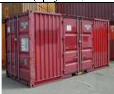
Slika 17. 20' Kontejner s bočnim vratima Izvor: http://www.dancontainers.dk (srpanj, 2013.)
