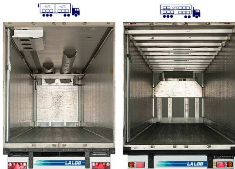
Slika 63. Hladnjače s 2 temperaturno režima i sa dvokatnim tovaranjem
