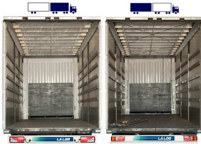
Slika 65. Cerada tandem: 110\text{m}^3 : (tegljač: 51\text{m}^3 , prikolica: 69\text{m}^3 )
