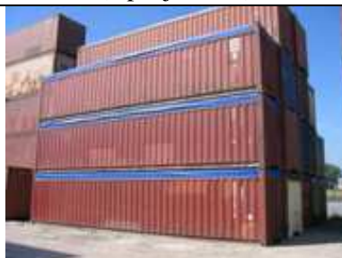
Slika 14. 40' Kontejner s otvorenim krovom Izvor: http://www.dancontainers.dk (srpanj, 2013.)
