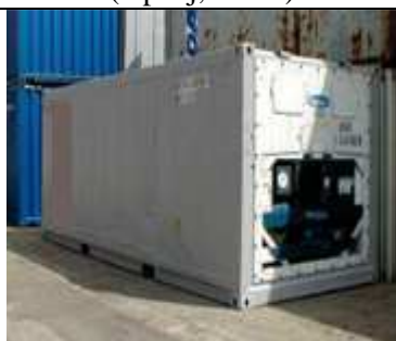
Slika 16. 20' Dizelski električni rashladni kontejner Izvor: http://www.dancontainers.dk (srpanj, 2013.)
