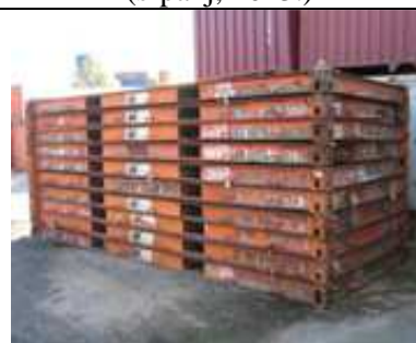
Slika 18. 20' Kontejner-platforma Izvor: http://www.dancontainers.dk (srpanj, 2013.)
