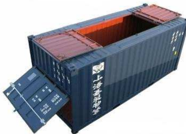
Slika 32. 20' ISO kontejner za prijevoz rasutih tereta
