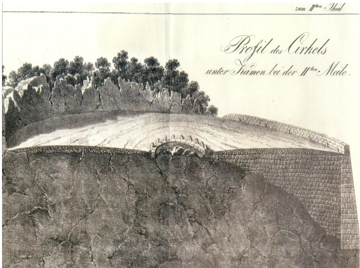
Slika 11. Veliki podzidani zavoj Cirkles ispod Kamenjaka, Vukasovićev nacrt
