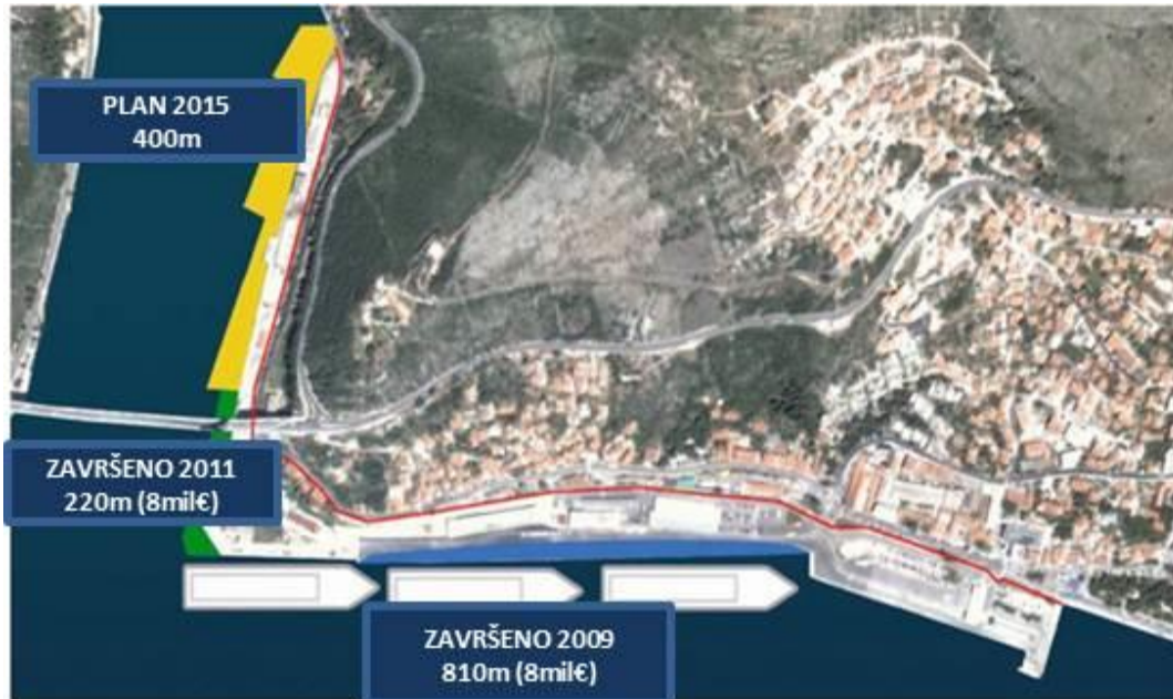
Slika 8: Faze obnove i proširenja luke Dubrovnik
